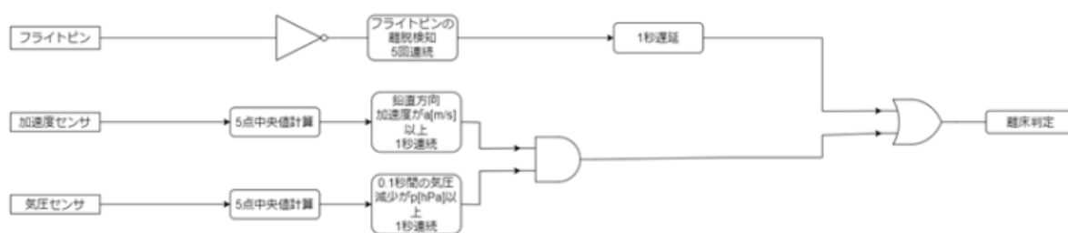
図 6.3.1 離床検知アルゴリズムの論理回路図
