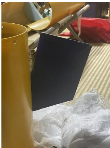
図 9.1 フィンの破損状況
