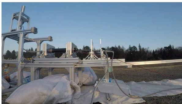
図 5.11 燃焼試験装置
