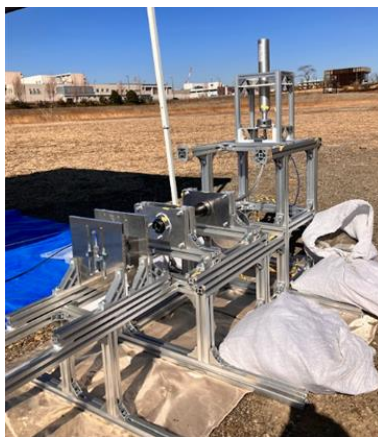
図 5.12 燃焼試験装置
