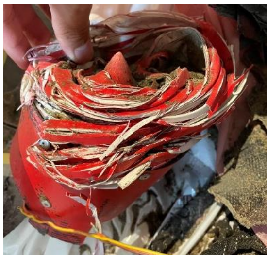
図 8.2.1 破壊されたノーズコーン
