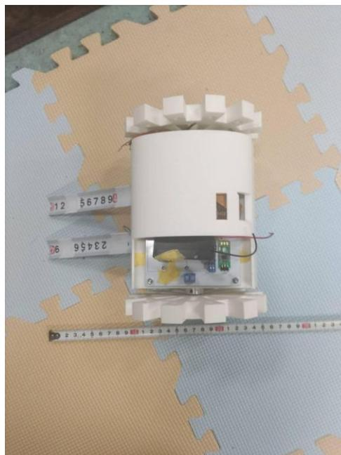
Fig. 2.7.2 機体外観図（スタビライザー展開時）
