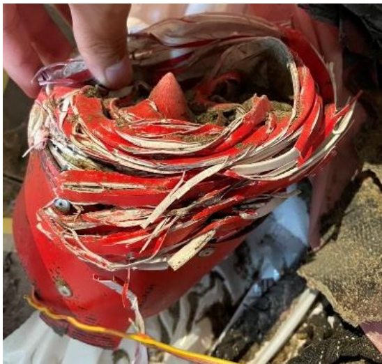
図 8.2.1 破壊されたノーズコーン
